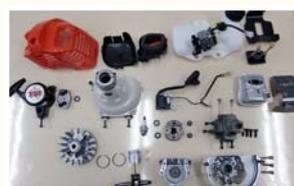
写真3: エンジンを分解した際の写真
