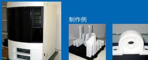
コンピュータの形状データから3次元形状を創成する装置。デザインした形状を迅速に作り上げ、確認したい場合に効果的。断面形状データはCADシステムから作成し、得られたSTL形式のデータを造形装置に伝送すれば造形作業は自動的に行われる。
