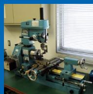
試作や単品部品加工に適した、旋盤・縦フライス盤・ボール盤が複合された工作機
