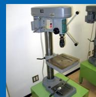
金属やプラスチックの穴加工に適した小型ボール盤
