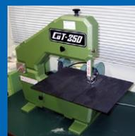
薄い板やプラスチック板の切断に適した帯ノコ盤
